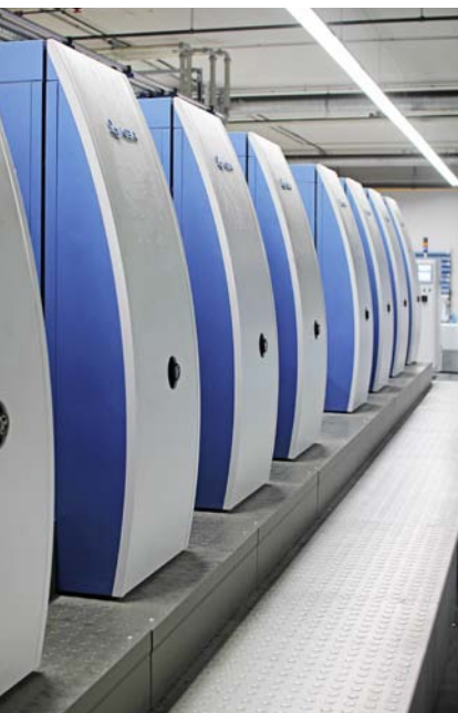
Das moderne Druckverfahren sorgt mit LED-Trocknung und UV-Farben für eine hohe Produktionssicherheit.
